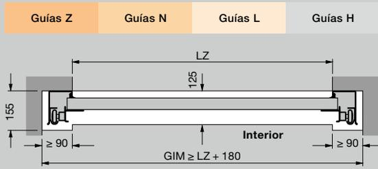
Montaje con guías Z, N, L
